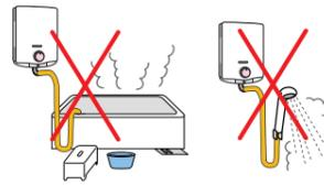
**お勧め** 不完全燃焼防止装置の無い小型湯沸器は不完全燃焼防止装置付きの機器にお取替えください。(炎の異常を感じ自動的にガスを止め、不完全燃焼を防止します。)
