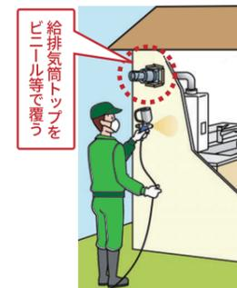
★養生したままガス・石油機器を使用すると危険な箇所
