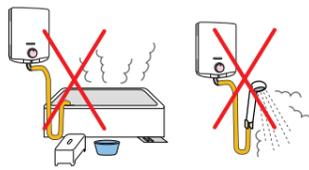
**お勧め** 不完全燃焼防止装置の無い小型湯沸器は不完全燃焼防止装置付きの機器にお取替ください。(炎の異常を感じ自動的にガスを止め、不完全燃焼を防止します。)
